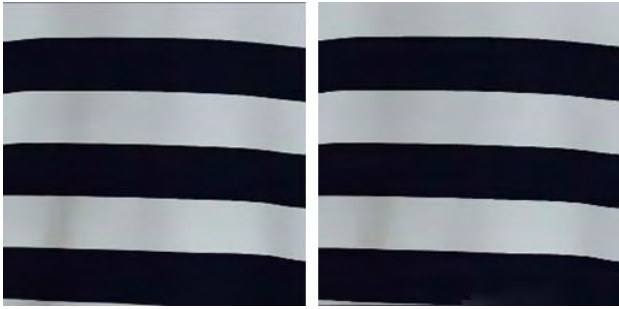
(그림 2) Bilateral 필터를 적용한 이미지(왼쪽), Bilateral 필터와 Mean-Shift 알고리즘을 적용한 이미지(오른쪽)
